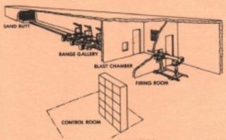
SCHEMATIC OF THE FREE FLIGHT AERODYNAMIC RANGE
